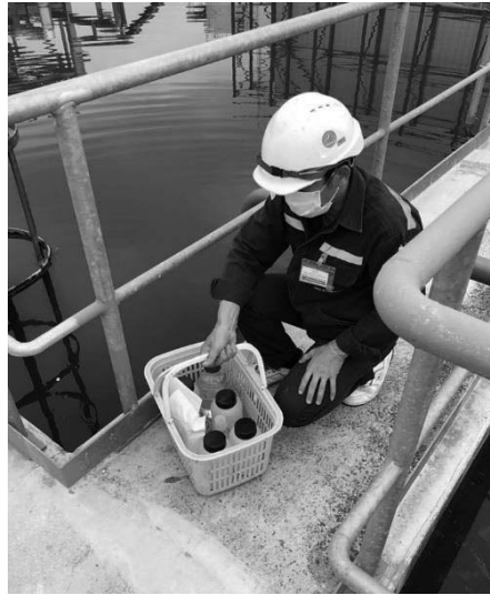
รูปเก็บตัวอย่างน้ำหล่อเย็น
